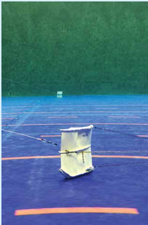
Figiúr 1: Doirse tráil ar taispeáint sa tanc flúma; is é feidhm na ndoirse ná an líon a choinneáil oscailte san uisce.
